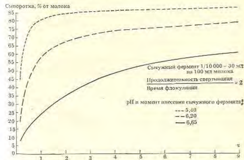
Рис. 2.3. Изменение хода выделения сыворотки из сгустка во времени для сычужных сгустков, подкисленных молочной кислотой (средние данные по шести экспериментам)
