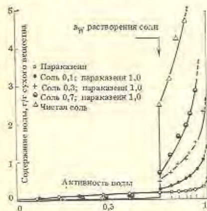
Рис. 3.2. Изотермы адсорбции водяного пара различными смесями параказина и соли при 20 °C
