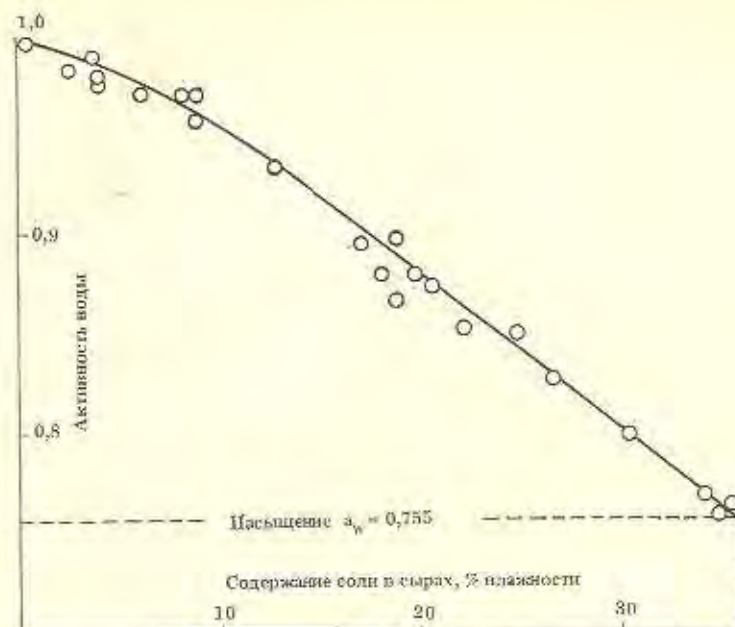
Рис. 3.3. Снижение активности воды в сырах типа камамбер непосредственно после выделения сыворотки с использованием возрастающих количеств хлорида натрия (при 20°C)
