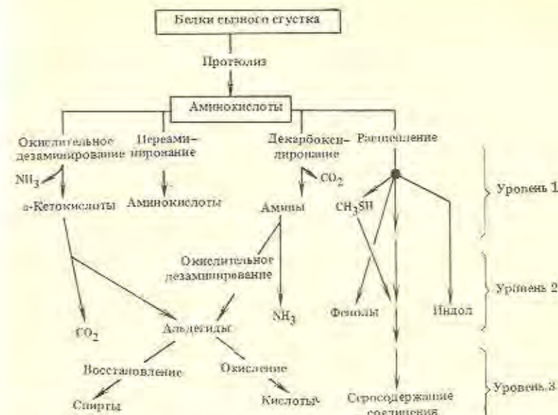
Рис. 4.10. Общая схема микробного катаболизма аминокислот в процессе созревания сыра [131]
