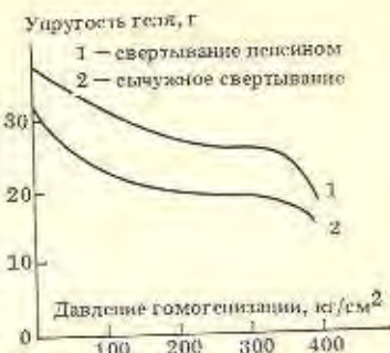
Рис. 6.9. Воздействие гомогенизации на упругость сычужного геля
