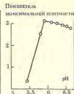
Рис. 1.10. Влияние pH на скорость уплотнения и максимальную плотность сычужного сгустка [38]
